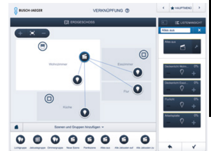
Dritter Schritt - das Verknüpfen. Im letzten Schritt erfolgt die grafische Einordnung von Sensoren und Aktoren sowie die Erstellung von Zentralbefehlen und Lichtszenen.
