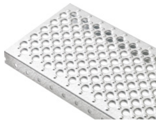
STEPCLAIR® N rutschhemmende Oberfläche mit Reliefnoppen und vertieften Öffnungen ca. Ø 18 mm
