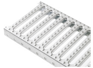
STEP PLUS® N rutschhemmende Oberfläche mit Reliefnoppen und nach unten ausgestanzten Schlitzern zur Verstärkung der Quersteife
